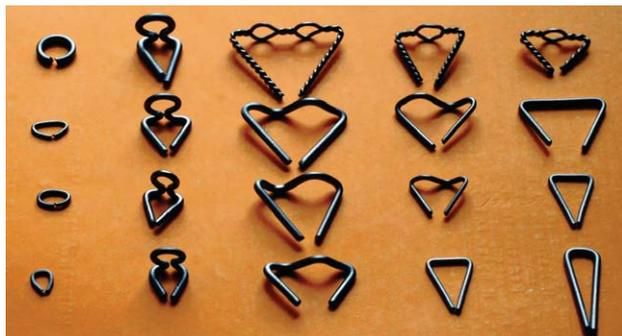
Рис. 2. Фиксирующие конструкции из никелида титана с памятью формы
