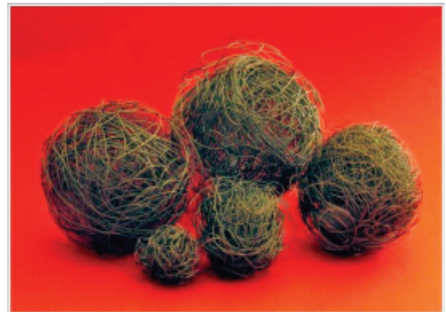
Рис. 11. Волоконный никелид титана
