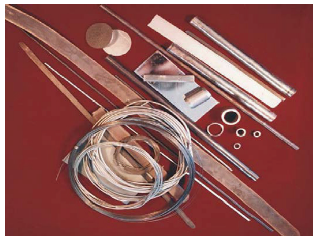
Рис. 3. Монокристаллические сплавы на основе никелида титана Fig. 3. Monolithic alloys based on titanium nickelide
