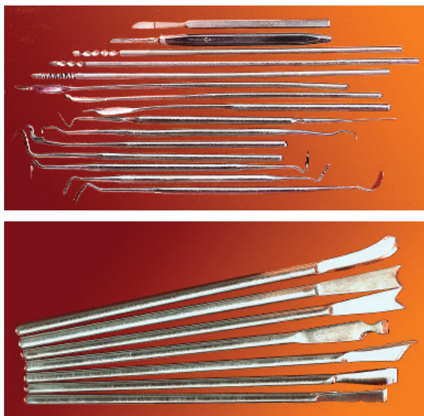
Рис. 17. Хирургические инструменты из никелида титана Fig. 17. Surgical instruments made of titanium nickelide
