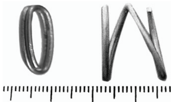
Рис. 1. Эллипсовидная конструкция в сомкнутом (слева) и разведенном (рабочем) (справа) положении
