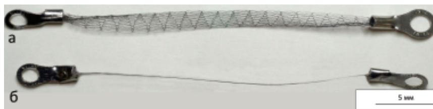
Рис. 1. Металлотрикотаж (а) и сверхэластичная проволока (б) из никелида титана
