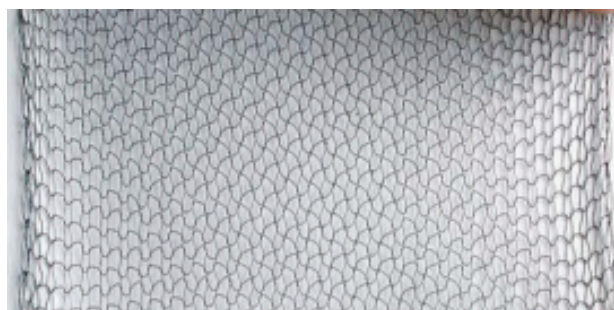
Рис. 14. Трикотажные материалы из тонких (40–60 мкм) нитей
