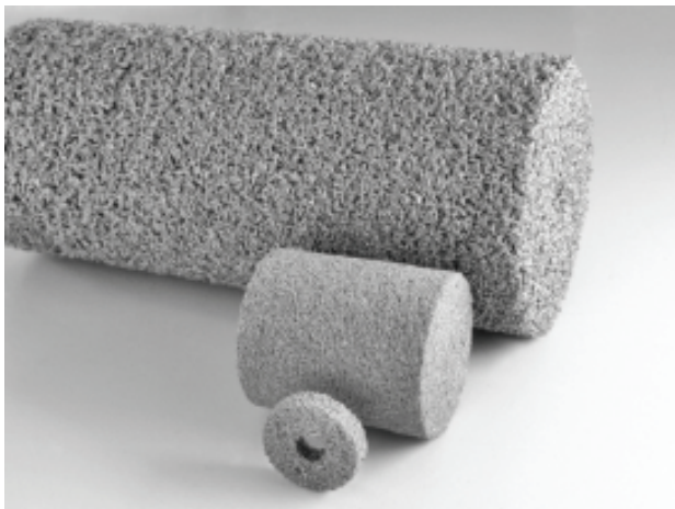
Рис. 5. Пористо-проницаемый материал на основе никелида титана
